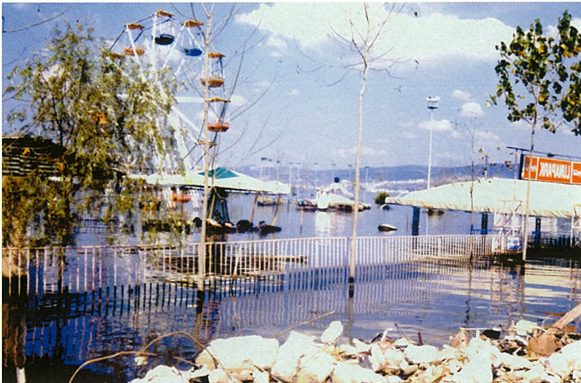
17 Ağustos 1999 Depremi sırasında oluşan yanıl yayılmaya bağlı kıyının denize doğru hareketi, Gölcük (Fotograf: Adil Binal)
